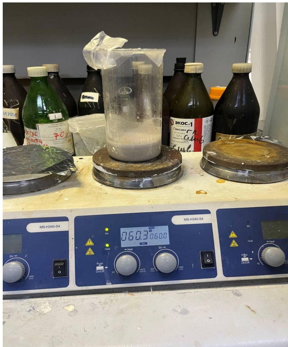
Рисунок 6-Кислотная обработка золы уноса на магнитной мешалке
