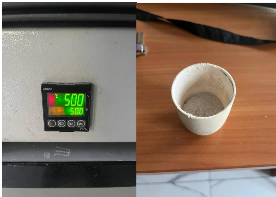
Рисунок 11 – Процесс плавления в муфельной печи
