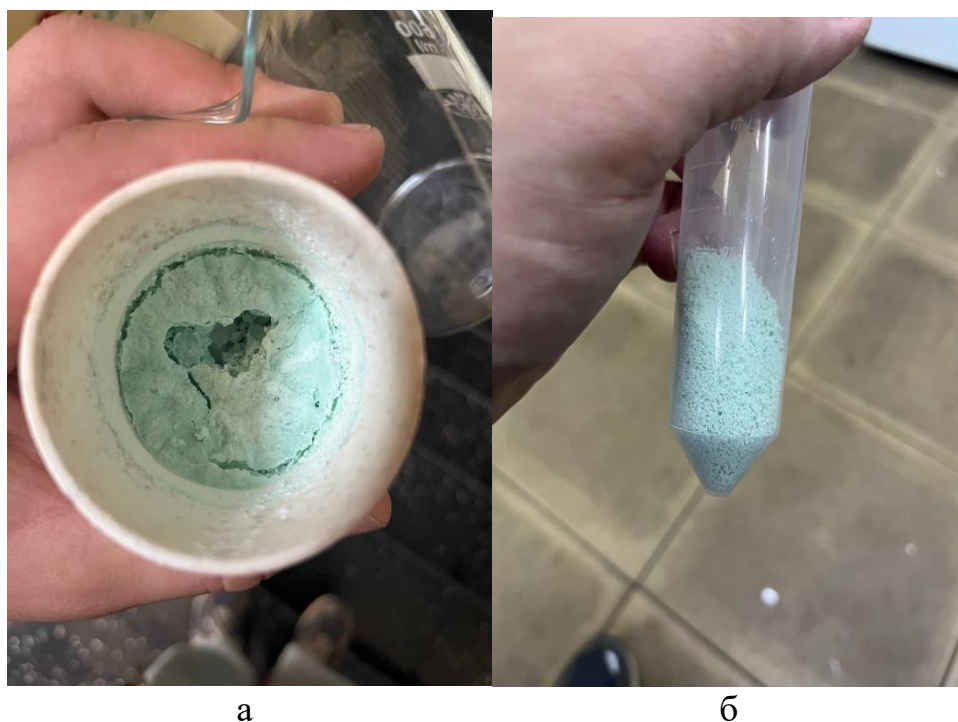
Рисунок 12 – Спеченная (а) – масса после плавки, (б) – масса после измельчения
